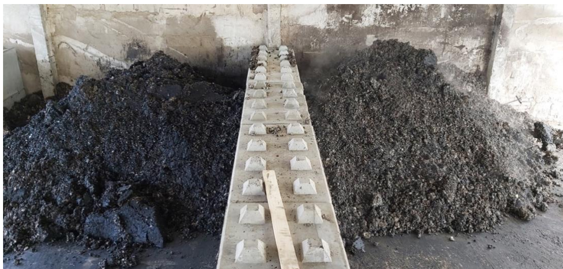
Obrázek 8: Předkompostovaná směs čistírenského kalu I. (vlevo) a čistírenského kalu II. s nasávanou kartonáží (vpravo) (autor Ing. Milan Hrčka)
