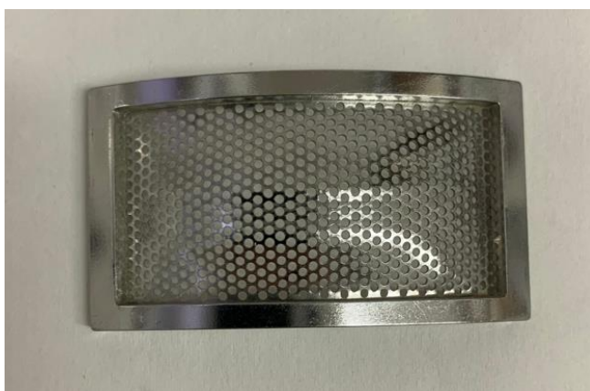
Obrázek 15: Síto do malého mlýnu IKA – F 10 basic o velikosti průlin 1 mm (vlastní zdroj)
