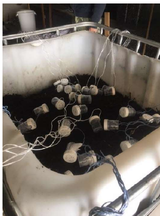
Obrázek 6: Umístění patron v pokusu před překrytím dalším materiálem
