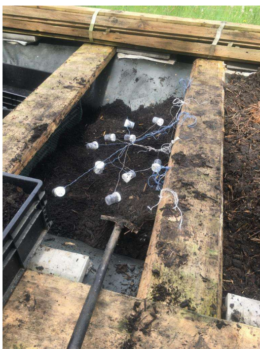
Obrázek 6: Umístění patron v pokusu před překrytím dalším materiálem
